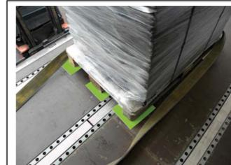
Bild 1: Anordnung der RhM Pads unter den Kufen – Zug längs zu den Kufen
