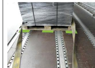
Bild 2: Anordnung der RhM Pads unter den beiden äußeren Kufen – Zug quer zu den Kufen
