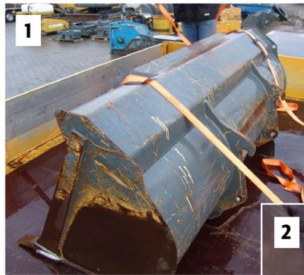
1. Anbringen der Spanngurte mit eingefädeltm Antirutsch-Kantenschutz-Pad (BCP-KSF)
