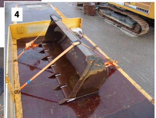
4. Im Test blieb der Gurt arriert, bei Verwendung der BCP-Antirutschmatte als Unterlage !
