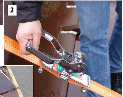
2. Mittels Vorspann-Messgerät wurde die Vorspannkraft vorschriftsmäßig, nach gesetzlichen Vorgaben überprüft. Es wurde kein nennenswerter Verlust festgestellt
