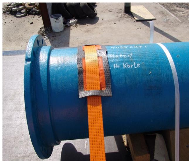
Sicherung beidseitig mit Spanngurten an den LKW-Ösen des Ladebodens und zusätzliche Einsatz von **BCP-KSF „Duplex“ Antirutsch-Kantenschutz-Pads.**
